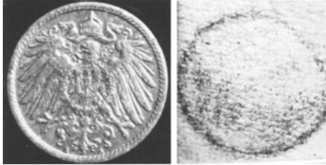
Abb. 3. Elektrische Metallisation einer Nickelmünze. Auch hier sind die punktförmigen Stromdurchtrittsstellen (Schießscheibenform) zu erkennen
